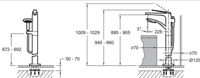
Спецификация продукта: Однорычажный напольный смеситель для ванны/душа. E97367. Коллекция: AVID. ВЕС: 13 кг. ТИП УСТАНОВКИ: Напольные. ТИП: Однорычажный. РАСХОД ВОДЫ: 24 л/мин. ВЫСОТА ПОД ИЗЛИВОМ: 940 - 960 мм. РАССТОЯНИЕ МЕЖДУ ЦЕНТРОМ ИЗЛИВА И ЦЕНТРАЛЬНОЙ ОСЬЮ КОРПУСА: 226 мм. МЕХАНИЗМ: Керамический картридж. СЛИВ: 0. ОДНОРЫЧАЖНЫЙ СМЕСИТЕЛЬ: МЕХАНИКА. УСТАНОВКА: Напольные. ГАРАНТИЯ НА ОТДЕЛКУ: 10 лет на покрытие "Хром" и 25 лет на покрытие "Полированный никель".
